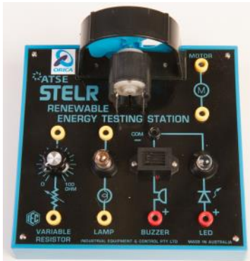
Test rig module
